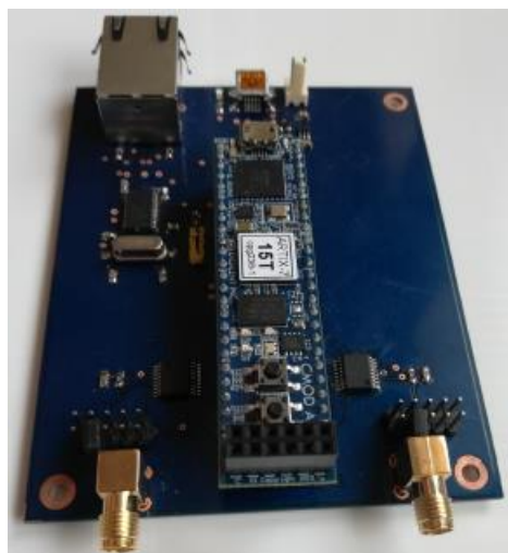
Rys. 9. Układ do akwizycji danych dla kwantowych generatorów liczby losowych
