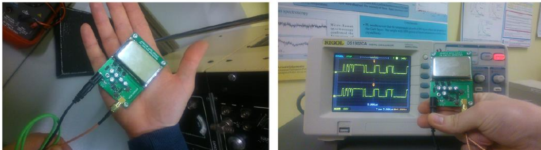
Rys.1. Zdjęcia poglądowe prototypowego układu kwantowego generatora liczb losowych wytworzonego według własnej specyfikacji w oparciu o zjawisko kwantowego szumu śrutowego w toku realizacji projektu JURAND
